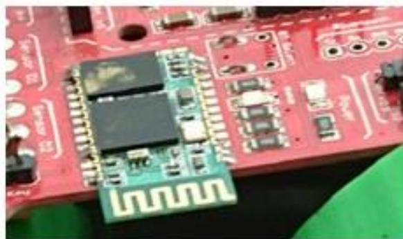
Figura 3: Tarjeta de control mostrando el módulo Bluetooth
